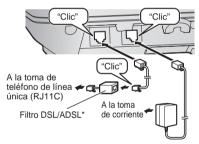
\*Se requiere un filtro DSL/ADSL (no incluido) si tiene servicio de DSL/ADSL.
