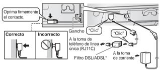
\*Se requiere un filtro DSL/ADSL (no incluido) si tiene servicio de DSL/ADSL.
